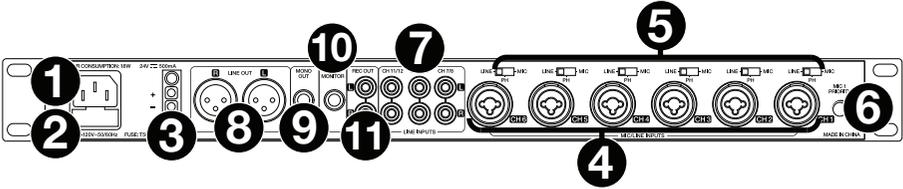
1. **AC 電源端子**：付属の電源ケーブルを接続します。また、下で説明します DC 電源端子からでも電源供給可能です（AC 電源と DC 電源がどちらも接続されている場合は、DN-312X は、AC 電源から電源を取得します）。
